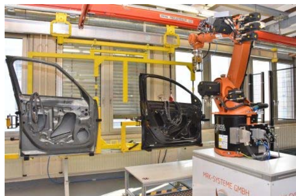
Ausgezeichnet: Die roboterbasierte Anlage montiert elastische Türdichtungen.
