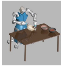
Rendering del robot RoDyMan intento a stendere l'impasto di una pizza, condirlo e cuocerlo www.rodyman.eu
