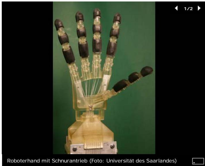
Roboterhand mit Schnurantrieb (Foto: Universität des Saarlandes)
