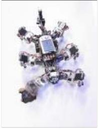
verschiedene Gangarten. Wissenschaftler aus Göttingen haben nun einen Roboter entwickelt, der je nach Situation flexibel zwischen mehreren verschiedenen Gangarten hin- und herschalten kann. Der Erfolg liegt in der Einfachheit: Ein einziges kleines Verschaltungsnetzwerk mit nur wenigen Verknüpfungen kann... [mehr](#)
