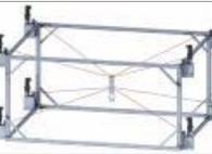
**Am Fraunhofer IPA wurde ein neuartiger Roboter entwickelt und in Betrieb genommen. Er basiert auf Seilen, die durch mehrere Winden angetrieben werden und einen Endeffektor im Raum bewegen.**
