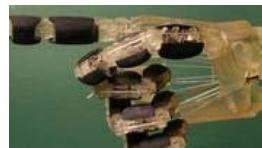
BERLIN. Eine uralte Technik, die schon die Römer angewandt haben, soll Roboter künftig besser greifen lassen. Wissenschaftler der Universität des Saarlandes in Saarbrücken haben einen neuen Antrieb für Roboterhände entwickelt: Schnüre sollen die Kraft auf die Finger übertragen.
