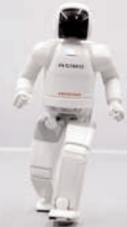
Asimo è un robot umanoide, alto 120 cm: sa correre, ballare e salire le scale.
