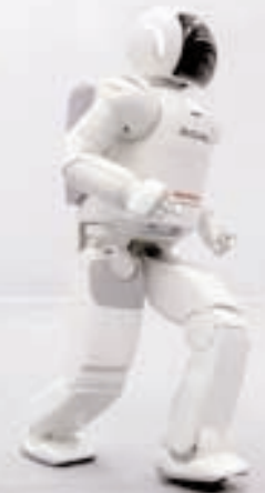
Asimo è un robot umanoide, alto 120 cm: sa correre, ballare e salire le scale.
